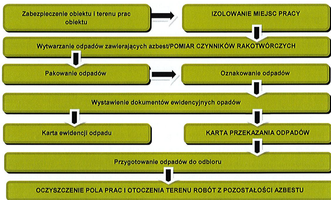
Rysunek 12. Schemat procedury dotyczącej prac polegających na usuwaniu wyrobów zawierających azbest, wytwarzania odpadów niebezpiecznych wraz z oczyszczaniem obiektu/terenu/instalacji.
