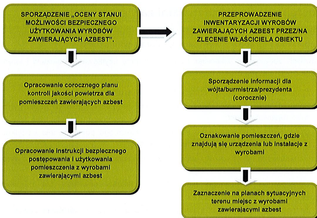
Rysunek 9. Schemat procedury dotyczącej obowiązków i postępowania właścicieli i zarządców przy użytkowaniu obiektów i terenów z wyrobami zawierającymi azbest.
